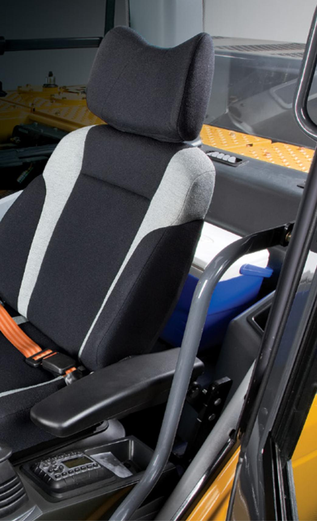
密封良好的增压驾驶室噪音低，有助于减少操作手疲劳。驾驶室的硅油减震支撑能进一步隔离噪音和振动。
