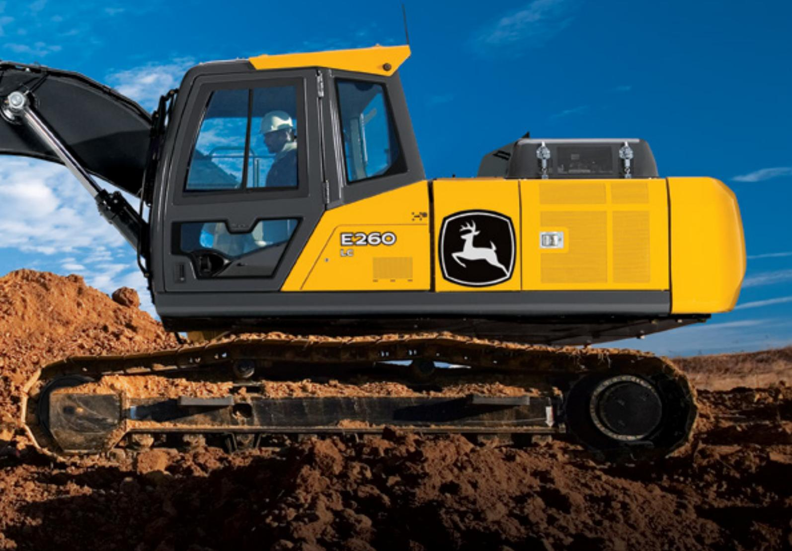
1. 提供四种液压动力模式，从而使操作人员能够选择发动机功率和燃油效率的最佳组合。其中，低功率模式/经济模式，可以限制发动机转速和液压动力，从而有助于减少燃油消耗；标准功率模式，适用于普通作业类型，能够保持功率、速度和燃油经济性的相互平衡；高功率模式，可以提供更大的功率，以及更快的液压系统响应速度，从而提高作业效率。设有起重、挖掘、以及液压锤/双向液压辅助工作模式。操作人员可以根据具体的施工作业需求，来选择适宜的工作模式。通过密封开关模块控制，只需按下相应的按钮，即可选择合适的功率及工作模式设置来匹配相应的工作附件。
