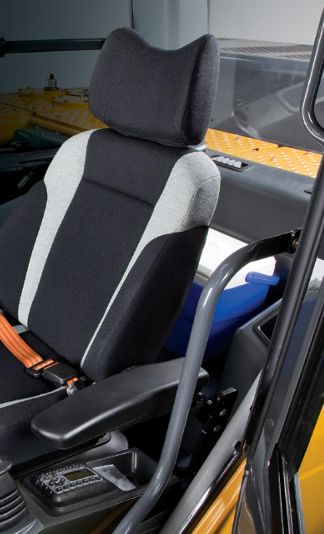
密封式增压驾驶室，噪音低，有助于操作人员减轻疲劳。驾驶室减震装置进一步降低噪音和振动对操作人员的影响。
