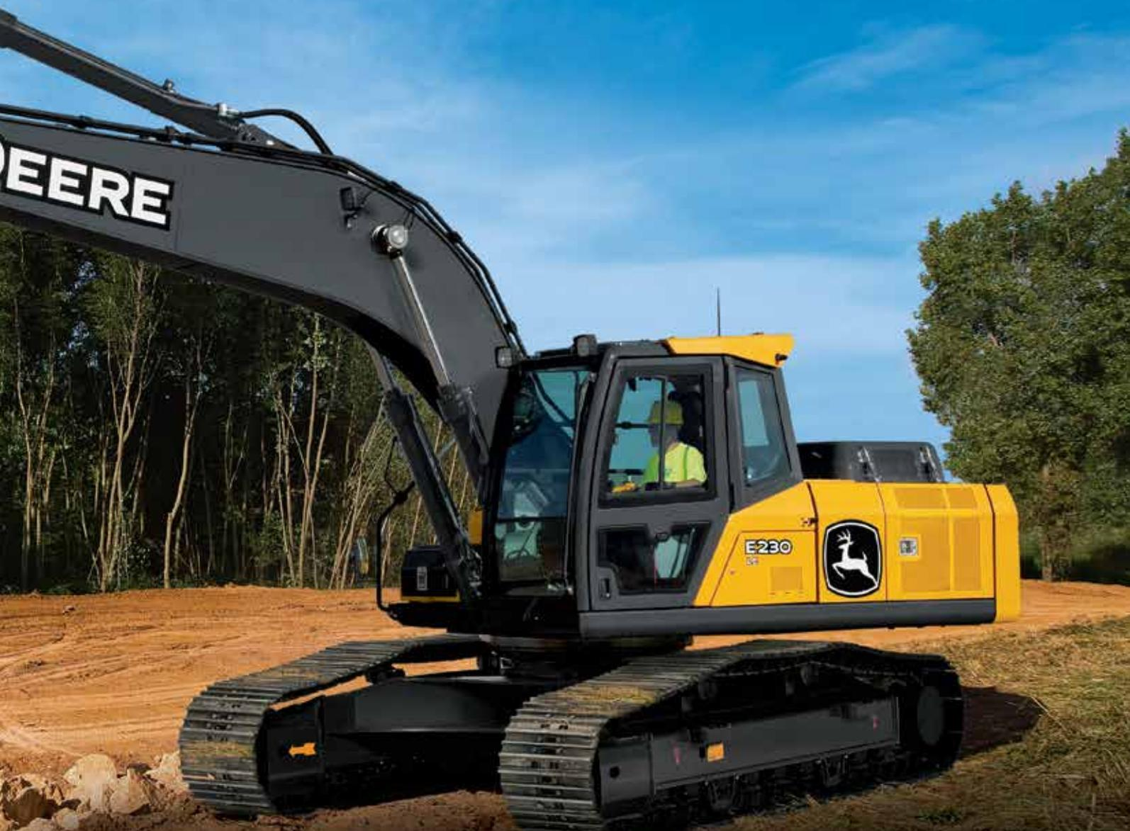
1. 提供四种液压动力模式，能够使操作人员选择发动机功率和燃油效率的最佳组合。其中，低功率模式/经济模式，可以限制发动机转速和液压动力，从而有助于减少燃油消耗；标准功率模式，适用于普通作业类型，能够保持功率、速度和燃油经济性的平衡；高功率模式，可以提供更大的功率，以及更快的智能液压控制系统响应速度，从而提高作业效率。设有起重、挖掘、以及液压锤/双向液压辅助工作模式。操作人员可以根据具体的施工作业需求，来选择适宜的工作模式。通过密封开关模块控制，只需按下相应的按钮，即可选择合适的功率及工作模式设置来匹配相应的工作附件。
